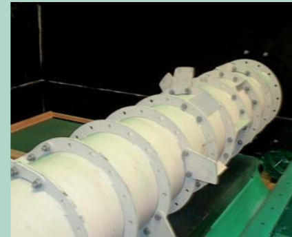
Rodillo dosificador y desintegrador con herramientas cambiables en acero inoxidable
