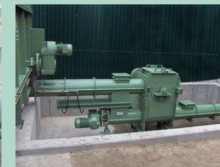
Técnica de trituración integrada en el recorrido de transporte
