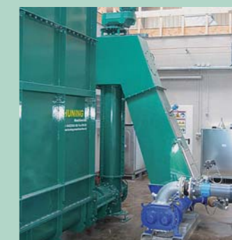
Entrega del dosificador de sólidos al sistema de bombeo
