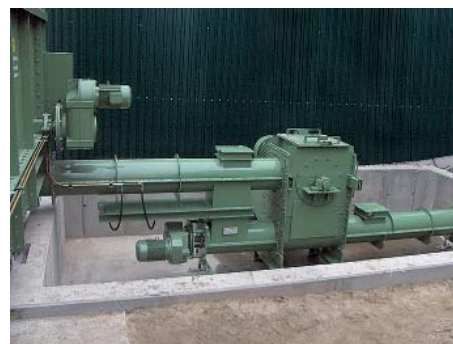
Техника размельчения встроена в линию транспортировки
