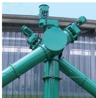
Вертикальное спиральное перемещение с двумя альтернативными путями подачи к ферментеру
