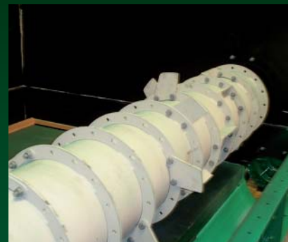
Дозирующие и измельчающие валки со сменными инструментами, исполнение из высококачественной стали
